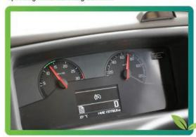
車速限制器提升了車隊的車速限制裝置的表現。現時當車速達到限制標準時,裝置會切 號級料供應,而車速限制器更配備自動剎車 功能,防止巴士落斜時超速。
