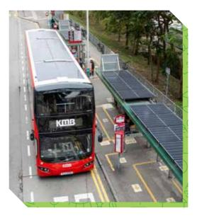
九巴引入第三代配備太陽能發電裝置的雙層巴士·裝置有助降低車廂溫度·並會供電予車廂內的電子系統·從而減少油耗。此外·九巴已在巴士車廠、巴士站及巴士車頂一共裝設約 30,000 塊太陽能光伏發電板·每年能夠利用可再生能源產生超過 1,300 萬度電力·相等於 4,000 個香港家庭一年的用電量·可以為香港減少大約 9,100 噸碳排放。九巴成為全港擁有最大太陽能發電系統的專營巴士公司·帶領香港公共運輸業邁向綠色新時代·同時為推動香港實現碳中和作出貢獻。
